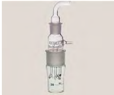
شکل ۵- بیوسمپلر مورد استفاده برای نمونه برداری بیوآئروسل (حاوی سه جت ایجاد کننده برخورد در سطح مایع)
